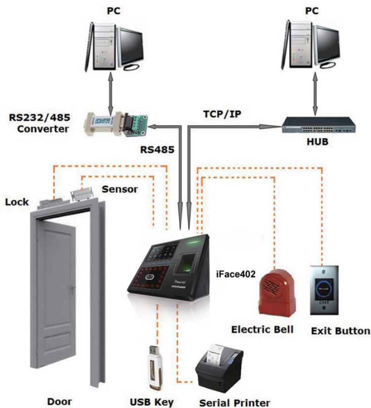
Verbindungsdiagramm eines FR402 Terminals.
